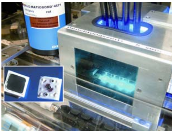
Abb 2.: Bei der Pinabdichtung an Kurzhub-Tastern wird ein Rot eingefärbter, licht-härtender Klebstoff verwendet, der in 5 s mit Hilfe von Lichtleiterlampen aushärtet.
